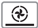
Hot air and bottom heater โปรแกรมนวดลมร้อนและอบล่าง (อบพิซซ่า)
